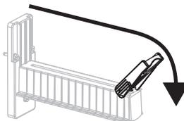
3. 将介质卷放入介质供应架。将纸卷尽量向后推。
